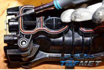
Den Plastikadapter, der die Drallklappenachse mit dem Drosselklappensteller verbindet entfernen.
