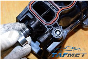
O-Ringe schmieren und Verschluss-Stopfen einstecken. Der Stopfen kommt nur schwer hinein, damit der Ansaugkrümmer dicht bleiben kann.
