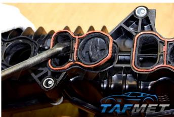
Die Drallklappen mit Dichtungen herausziehen.
