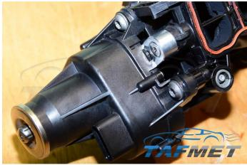
Sobald der Verschluss-Stopfen festsitzt, wird der Stellmotor angebracht, nachdem zuvor der Arm abgenommen worden war, der nicht mehr benötigt wird. Der Ansaugkrümmer wird an Motor angebracht, alle Leitungen werden hergestellt. Es soll kein Fehler auftauchen. Man muss auch keinen Motor umprogrammieren.
