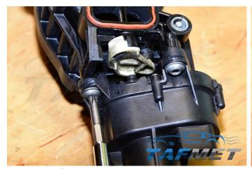
Den Ansaugkrümmer vom Motor trennen. Anschließend 3 Schrauben abziehen und das Stellglied der Drallklappen abbauen. Es wird empfohlen, den Ansaugkrümmer zu reinigen, um die Drallklappen leichter abzubauen.
