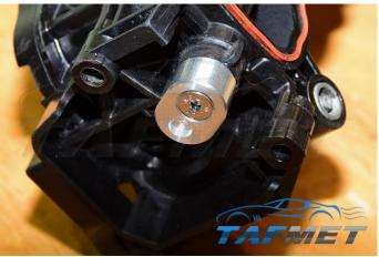
Damit der Verschluss-Stopfen bis zum Anschlag festsitzen kann, soll ein kleiner Hammer verwendet werden.
